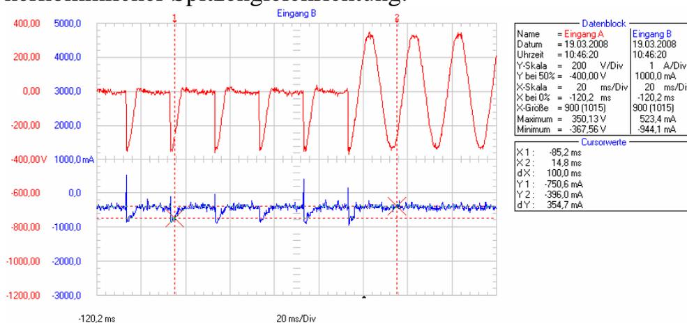
TSRL-test-snt-12.bmp, wie Bild 10 aber im Leerlauf ohne Last
