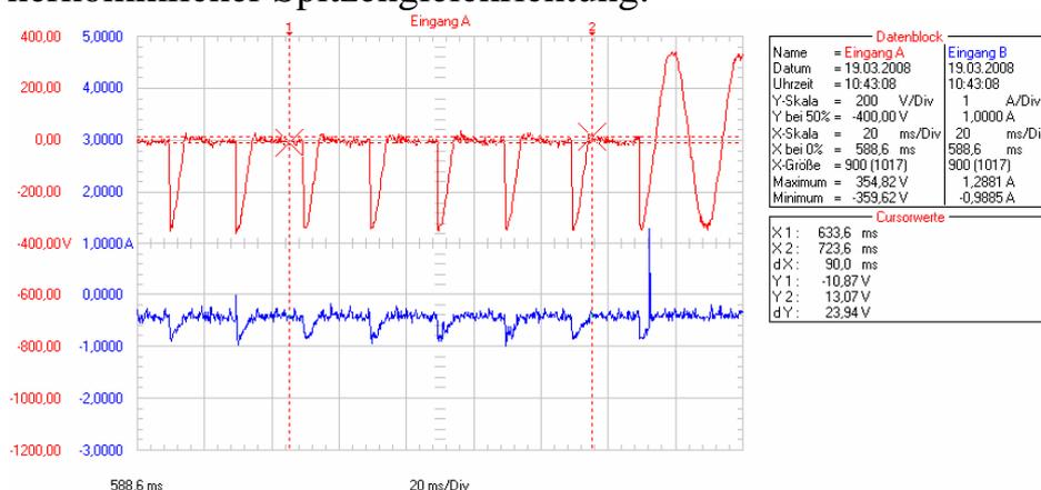
TSRL-Test-SNT-delta-10.bmp, mit SNT v. Delta-el. 19V,3,16A, ohne Powerfaktorkorr., mit Last gemessen, A= Uan EIng., B= Iin EIng.
