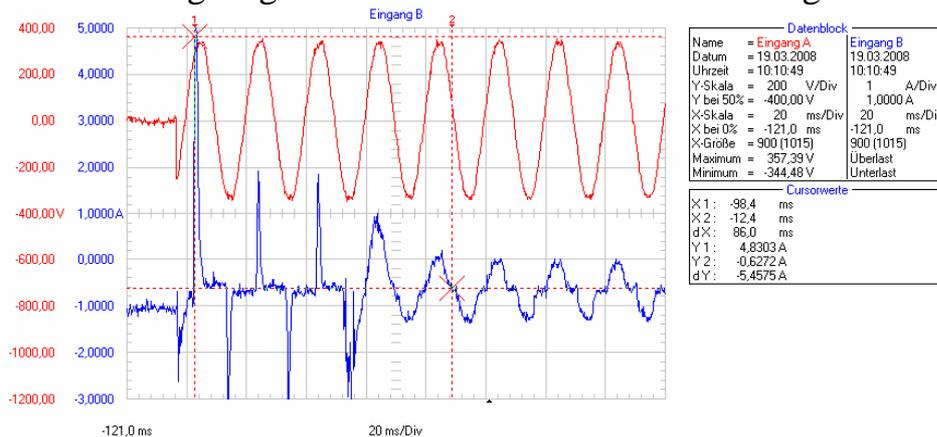
TSRL-test-snt-1.bmp, TSRL 22100310 auf Schaltnetzteil mit Last. A= Van SN T-Eingang, B=Iin Eingang v. SNT. Gemessen an Siemens S26113-E518-V15, mit und ohne Ohmsche Last gemessen. SNT hat Powerfaktorkorrektur.
