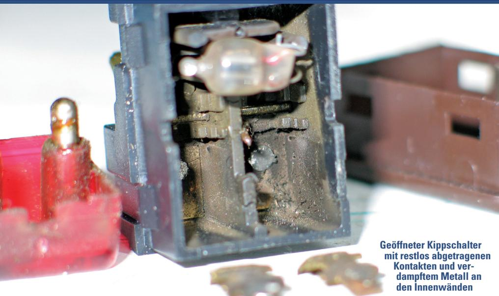
Geöffneter Kippschalter mit restlos abgetragenen Kontakten und verdampftem Metall an den Innenwänden
