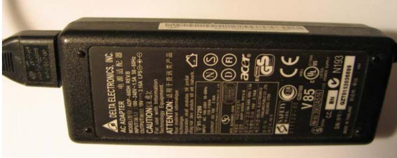
Schaltnetzteile, auch Power Adapter genannt, werden zum Beispiel für Laptops oder andere Geräte inzwischen vielfach in Büros und auch im Heimsektor verwendet. Diese Schaltnetzteile erzeugen beim Netz-Einschalten einen Einschalt-Stromstoß der die Absicherung der Netz-Steckdosen auslösen kann.
